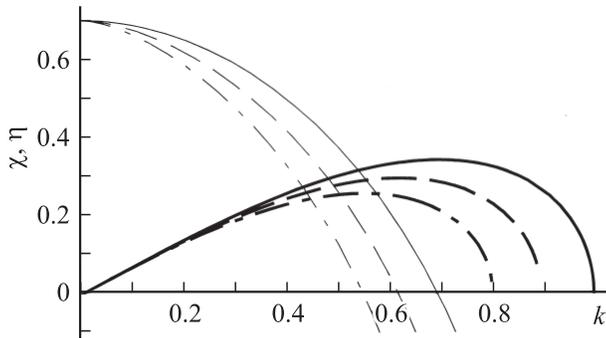
**Рис. 3.** Зависимости величины безразмерного инкремента неустойчивости осесимметричных волн  $\eta$  от безразмерного волнового числа — жирные кривые, и его производной по волновому числу  $\chi \equiv (\partial\eta/\partial k)$  — тонкие кривые, рассчитанные при  $\varepsilon_{ex} = 1$ ,  $\varepsilon_{in} = 2$  и различных значениях  $w$ :  $w = 0$  — сплошные кривые; 0.5 — пунктир; 1 — штрихпунктир.
