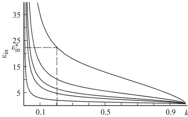
**Рис. 2.** Зависимости  $\varepsilon_{in} = \varepsilon_{in}(k)$ , построенные при  $\varepsilon_{ex} = 1$  и различных значениях параметра  $w$ :  $w \in \{0.05; 0.2; 0.5; 1; 10\}$ . Кривые расположены в порядке изменения параметра  $w$ : верхняя кривая соответствует  $w = 0.05$ , нижняя — 10.
