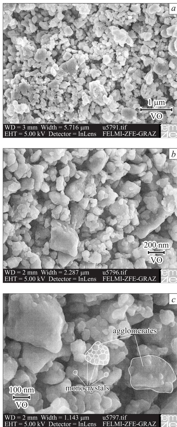
**Рис. 4.** Картина высокого разрешения порошков монооксида ванадия после размолта в течение 4 h. *a* — равномерное распределение округлых частиц по объему; *b* — крупные частицы являются агломератами; *c* — на картине видны агломераты, состоящие из большого количества монокристаллических частиц размером 20–30 nm.
