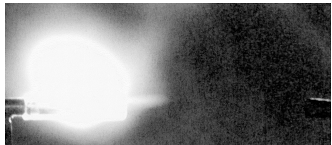
Рис. 12. СВЧ-разряд в пропан-воздушной струе при коэффициенте избытка горючего \Phi = 0.8 .
