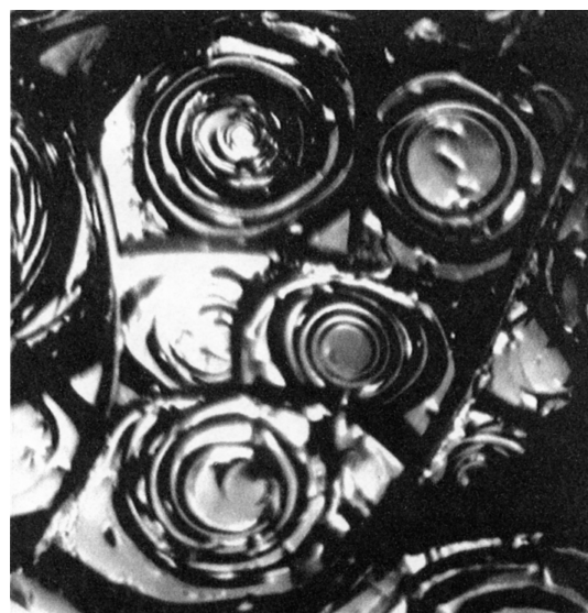
Рис. 17. Образование спиральных трещин в высыхающем яичном белке, помещенном в чашку Петри. Увеличение \times 28 .
