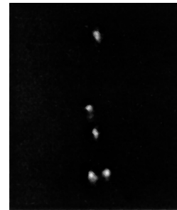
Рис. 3. Фрагмент кадра скоростной фотосъемки. I = 150 А, B_n = 0.35 Т, B_z = 0.2 Т, экспозиция 25 \mu s, t = 0.8 ms от поджига дуги. Материал электродов CuCr30.
