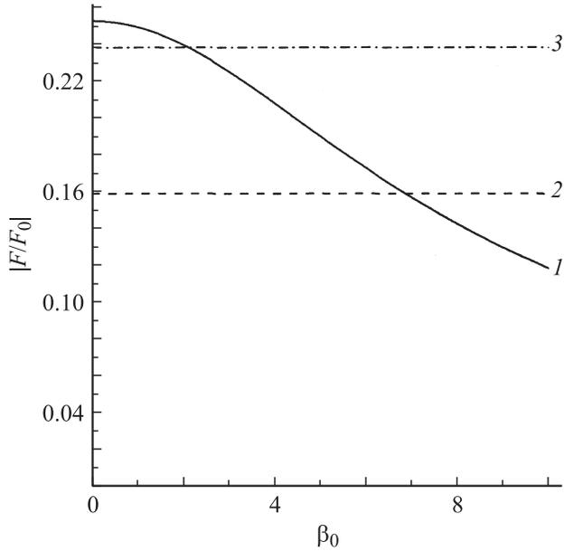
**Рис. 11.** Зависимости  $F_x$  (кривая 1) и  $F_y$  (2 и 3) проекций интегральной силы Лоренца, действующей на локально ионизированный поток при  $r_1/r_0 = 0.8$ ,  $r_2/r_0 = 1.2$ ,  $v_x = v_0$ ,  $v_y = 0$ ,  $E_z/(B_0v_0) = 0.5$  (2),  $E_z/(B_0v_0) = 0.75$  (3).
