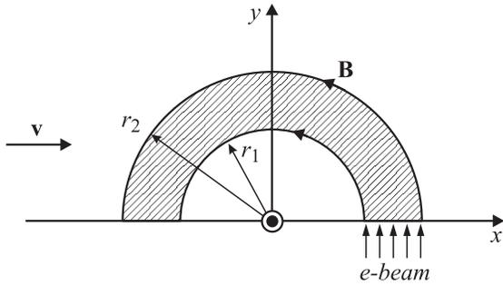
**Рис. 2.** Геометрия локально ионизованной области, создаваемой электронным пучком в неоднородном магнитном поле, используемая при нахождении электрического потенциала в МГД-течении.
