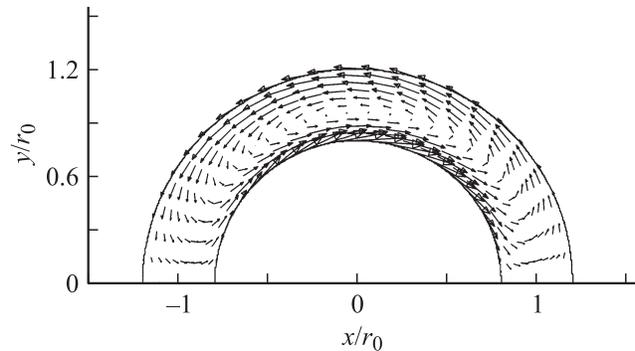
**Рис. 5.** Векторное поле плотностей токов в плоскости  $xu$  при  $\beta_0 = 10$ ,  $E_z = 0$ ,  $r_1/r_0 = 0.8$ ,  $r_2/r_0 = 1.2$ ,  $v_x = v_0$ ,  $v_y = 0$ .
