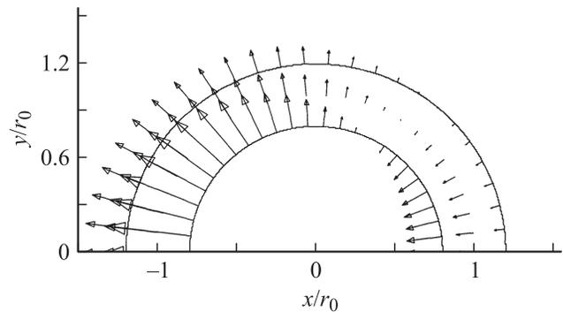
**Рис. 10.** Векторное поле силы Лоренца при  $\beta_0 = 1$ ,  $E_z/(B_0 v_0) = -0.5$ ,  $r_1/r_0 = 0.8$ ,  $r_2/r_0 = 1.2$ ,  $v_x = v_0$ ,  $v_y = 0$ .
