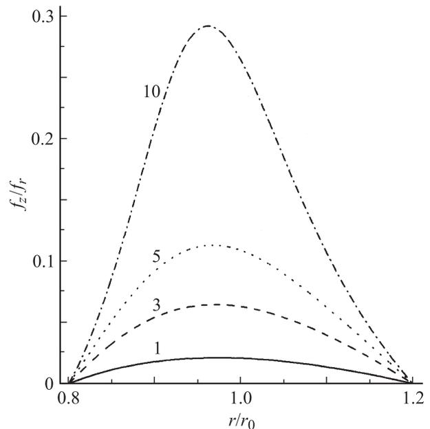
**Рис. 6.** Радиальное распределение отношения проекций  $f_z/f_r$  для различных значений параметра Холла  $\beta_0$  при  $E_z = 0$ ,  $r_1/r_0 = 0.8$ ,  $r_2/r_0 = 1.2$ . Величины  $\beta_0$  указаны у кривых.
