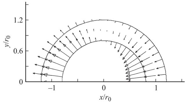
**Рис. 8.** Векторное поле силы Лоренца при  $\beta_0 = 1$ ,  $E_z = 0$ ,  $r_1/r_0 = 0.8$ ,  $r_2/r_0 = 1.2$ ,  $v_x = v_0$ ,  $v_y = 0$ .
