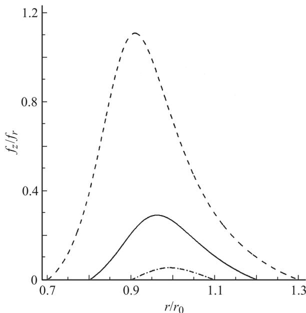
**Рис. 7.** Радиальное распределение отношения проекций  $f_z/f_r$  для различных геометрий областей ионизации потока при  $E_z = 0$ ,  $\beta_0 = 10$ . Пунктир  $r_1/r_0 = 0.7$ ,  $r_2/r_0 = 1.3$ , сплошная кривая  $r_1/r_0 = 0.8$ ,  $r_2/r_0 = 1.2$ , штрихпунктир  $r_1/r_0 = 0.9$ ,  $r_2/r_0 = 1.1$ .
