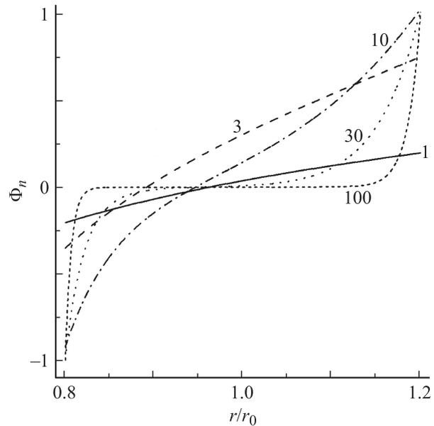
**Рис. 3.** Радиальное распределение нормированного электрического потенциала для различных значений параметра Холла  $\beta_0$  при  $\varphi = 0$ ,  $E_z = 0$ ,  $r_1/r_0 = 0.8$ ,  $r_2/r_0 = 1.2$ . Величины  $\beta_0$  указаны у кривых.
