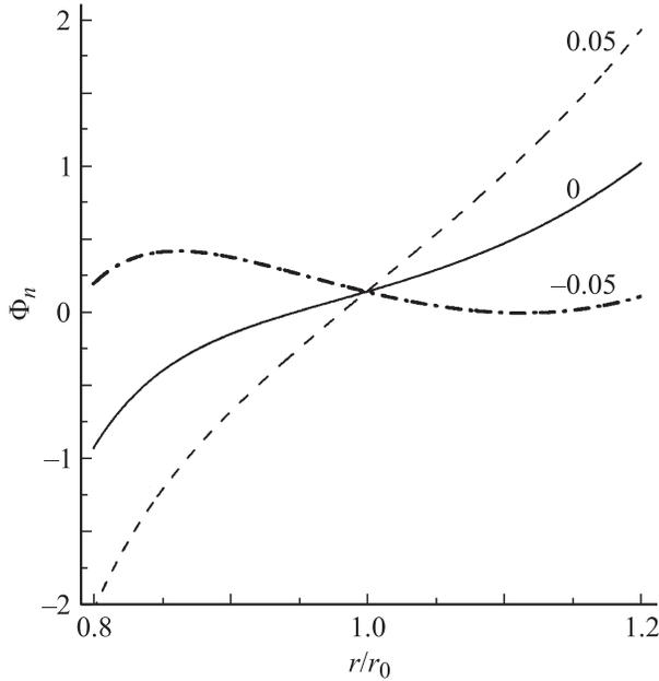
**Рис. 4.** Радиальное распределение нормированного электрического потенциала для различных значений поля  $E_z$  при  $\varphi = 0$ ,  $\beta_0 = 10$ ,  $r_1/r_0 = 0.8$ ,  $r_2/r_0 = 1.2$ . Нормированные значения поля  $E_z/(B_0 v_0)$  указаны у кривых.
