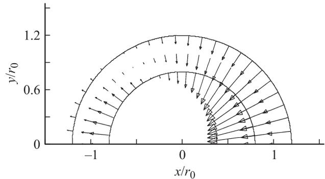
**Рис. 9.** Векторное поле силы Лоренца при  $\beta_0 = 1$ ,  $E_z/(B_0 v_0) = 0.5$ ,  $r_1/r_0 = 0.8$ ,  $r_2/r_0 = 1.2$ ,  $v_x = v_0$ ,  $v_y = 0$ .
