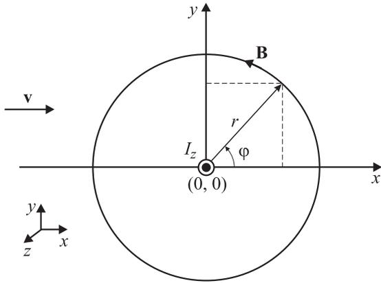
**Рис. 1.** Геометрия, используемая для нахождения электрического потенциала в МГД-течении в неоднородном магнитном поле, создаваемом прямолинейным током  $I_z$ .
