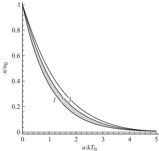
**Рис. 1.** Зависимость концентрации от потенциальной энергии: 1 — для классического идеального газа ( $\mu_0/kT_0 = 0$ ), 2 — для теплого ферми-газа при  $\mu_0/kT_0 \rightarrow 0$ , 3 — для теплого ферми-газа при  $\mu_0/kT_0 = 1$ ; недоступная область закрашена.
