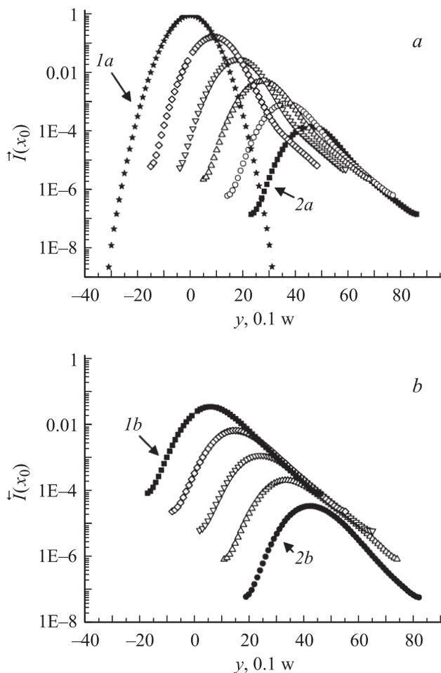
**Рис. 7.** Распределение интенсивностей полей прямого (а) и обратного (б) пучков в различных сечениях МС (выбранных с шагом в 20 периодов по глубине структуры Cr/Sc): 1а — падающий пучок, 1б — отраженный, 2а — прошедший, кривая 2б соответствует  $x_0 = (L + h) - 20d$  (при  $s_0 = L + h$  обратный пучок отсутствует).
