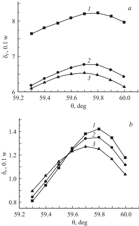
**Рис. 6.** Зависимость смещения центра тяжести спектрально широкого (*a*) и узкого (*b*) пучков от угла падения в единицах ширины пучка для разных шероховатостей: 1 —  $\sigma = 0$ , 2 — 3, 3 —  $6 \text{ \AA}$ .
