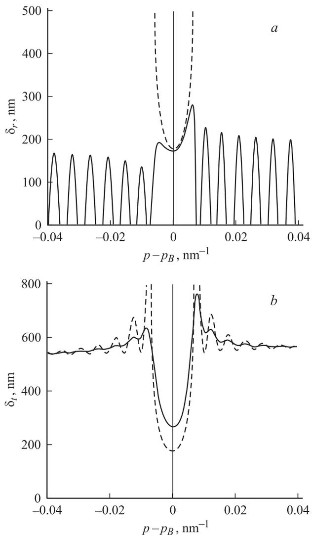
**Рис. 3.** Величина сдвига  $s$ -поляризованного пучка при отражении (а) и пропускании (б) в зависимости от отстройки для МС на основе Cr/Sc в случаях с поглощением (сплошная кривая) и без него (пунктир).
