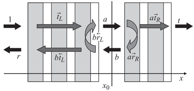
Рис. 2. Сечение структуры при вычислении распределения поля внутри МС.
