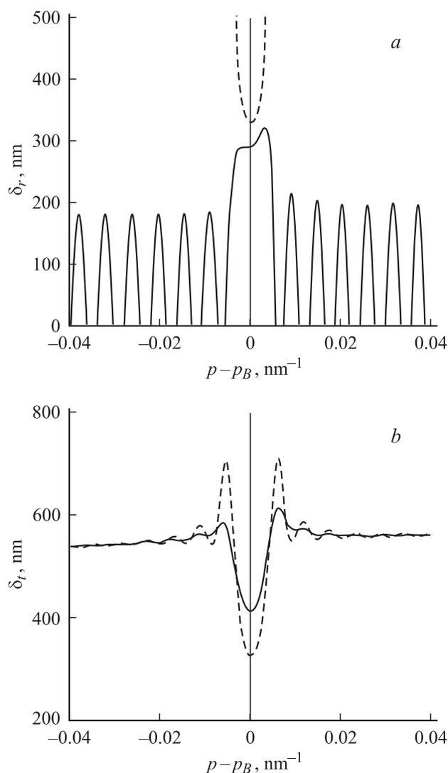
**Рис. 4.** Величина сдвига  $p$ -поляризованного пучка при отражении (а) и пропускании (б) в зависимости от отстройки для МС на основе Cr/Sc в случаях с поглощением (сплошная кривая) и без него (пунктир).
