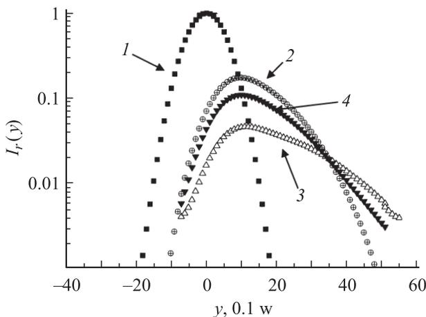
**Рис. 5.** Поведение интенсивностей спектрально широкого пучка при дифракции на Si/Sc МС: 1 — падающий пучок, 2 — отраженный  $s$ -поляризованный, 3 — отраженный  $p$ -поляризованный, 4 — отраженный неполяризованный пучок.
