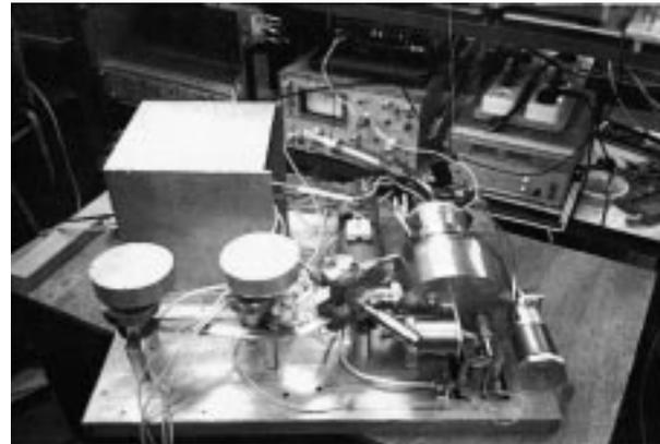
Рис. 4. Внешний вид мобильного масс-спектрометра.
