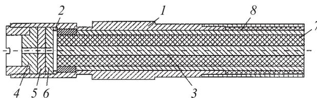
**Рис. 1.** Схема кабельного датчика: 1 — корпус; 2 — изолирующая прокладка; 3 — жила кабеля (электрод); 4–6 — коллиматор; 7 — изолятор кабеля; 8 — внешняя оболочка кабеля.
