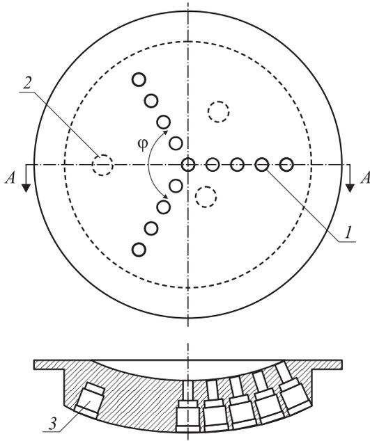
**Рис. 2.** Схема устройства для измерения пространственно-углового распределения электронов: 1 — входное окно кабельного датчика; 2 — положение фонового кабельного датчика; 3 — гнездо для фонового кабельного датчика.
