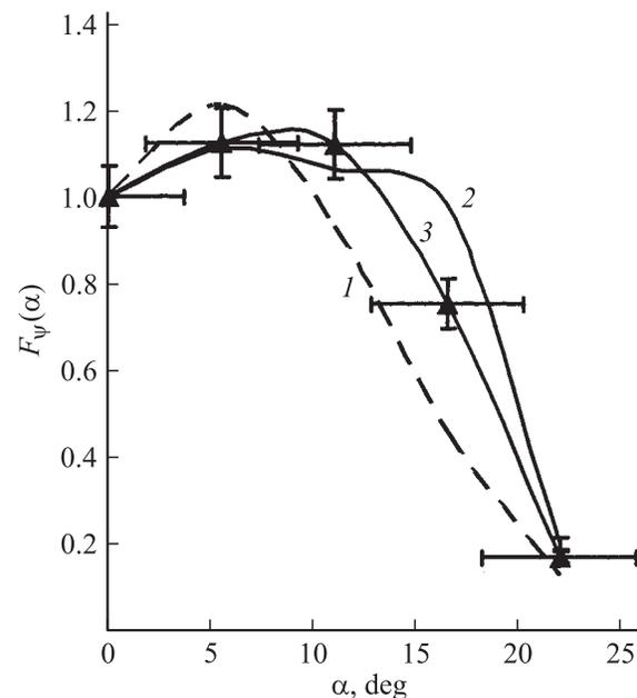
**Рис. 4.** Зависимости функции  $F_\psi(\alpha)$  от полярного угла  $\alpha$  для трех азимутальных направлений штатного режима работы ускорителя ЭМИР-М.
