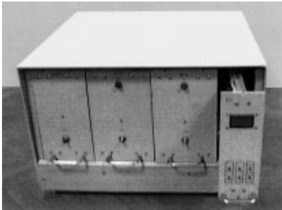
Рис. 2. Система питания прецизионных магнитных квадрупольных линз.
