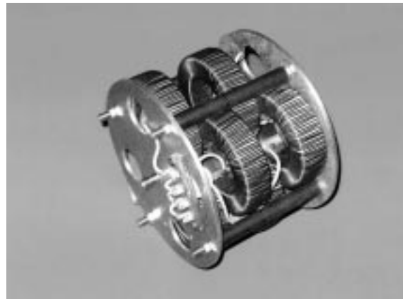
Рис. 5. Общий вид блочной сканирующей системы без корпуса.
