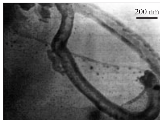
Рис. 4. УНТ, полученные на никелевой подложке без дополнительного введения катализатора.
