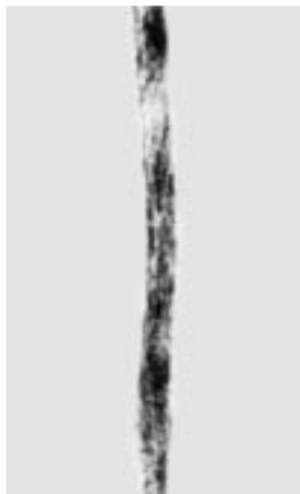
**Рис. 5.** Интегральное за импульс рентгеновское изображение плазмы в области фокуса.
