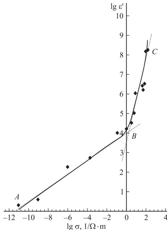
Зависимость действительной части диэлектрической проницаемости от объемной проводимости макросистемы парафин–графит, т.е.  $\lg \epsilon' = f(\sigma)$ .
