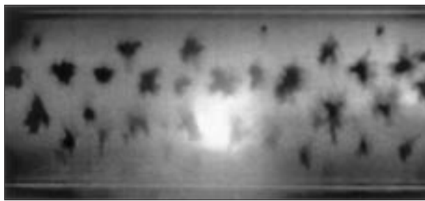
Рис. 5. Игольчатые кластеры („в торец“) после разбития одномерной структуры на несколько рядов в неоднородном внешнем магнитном поле. Направление магнитного поля перпендикулярно оси капилляра и плоскости фотографии.
