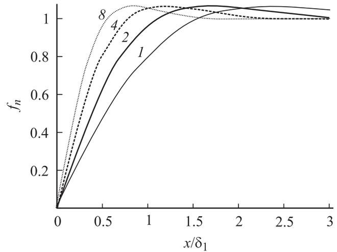
Рис. 2. Относительное распределение температуры и скорости в пограничном слое (около кривых — номера мод).
