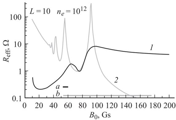
**Рис. 2.** Расчет: 1 — из работы [3], 2 — по формуле (2.24). *a* — область прозрачности плазмы к геликонному полю, *b* — область применимости геликонного предела.
