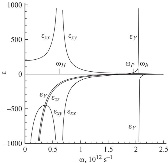
**Рис. 2.** Частотная зависимость элементов тензора  $\hat{\varepsilon}$  и фойгтовской диэлектрической проницаемости  $\varepsilon_V$  полупроводникового слоя периодической структуры.
