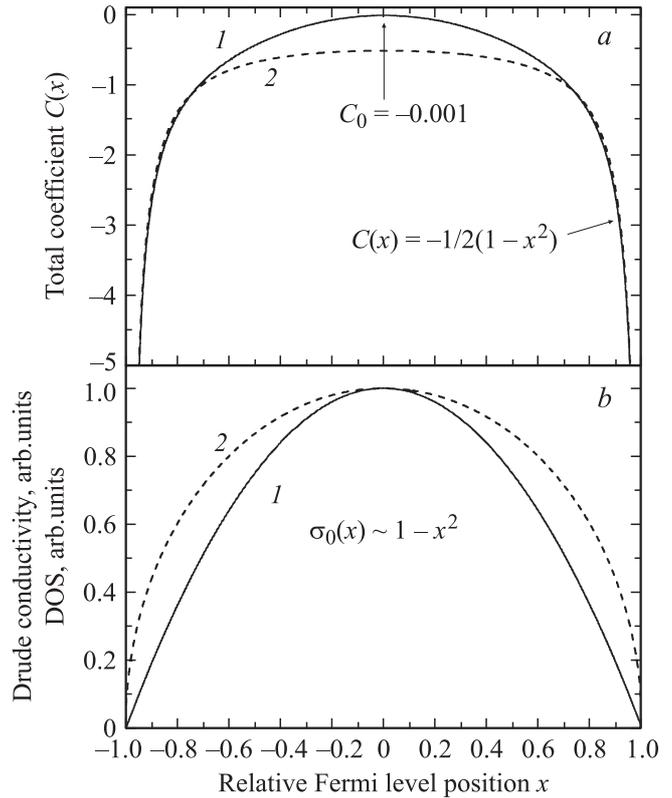
**Рис. 7.** Зависимости от относительного положения уровня Ферми внутри данного уровня Ландау,  $x$ :  $a$  — коэффициента  $C$  в пределах сильного (1) и слабого (2) магнитного поля;  $b$  — проводимости Друде–Андо (1) и плотности состояний DOS (2).
