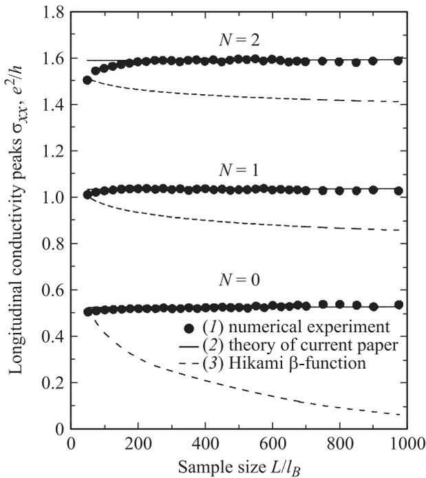
**Рис. 8.** Зависимости пиковых величин продольной проводимости, соответствующих уровням Ландау с номерами  $N = 0, 1, 2$ , от эффективного размера моделируемого образца: 1 — численный эксперимент, 2 — теория данной работы, 3 — теория работы [6].
