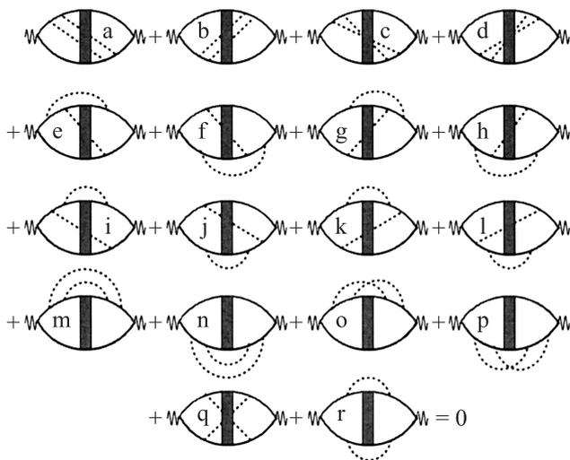
**Рис. 6.** Сокращение однодиффузных диаграмм со всевозможными комбинациями двух дополнительных примесных линий устраняет ультрафиолетовую расходимость отдельных диаграмм на рис. 2.
