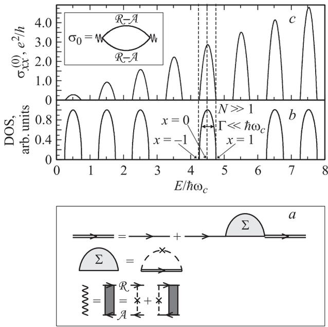
**Рис. 1.** Базовые уравнения и результаты самосогласованного борновского приближения (ССБП) в пределе  $\omega_c \tau \gg 1$ . *a* — уравнения ССБП для усредненных по беспорядку функций Грина, собственно-энергетической части и диффузона; *b* — плотность состояний (DOS) в форме полукруга; *c* — проводимость Друде–Андо согласно формуле (11).
