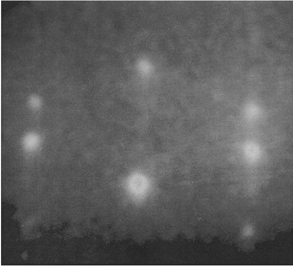
Рис. 1. Картина ДБЭО после осаждения 200 нм GaAs на оксидированную поверхность Si(111) при температуре 610°C.
