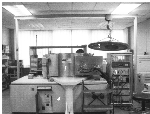
Рис. 5. Спектрометр пятого поколения STAR, фирма Samsung Electronics, г. Суwon, Ю. Корея. Обозначения: 1 — вакуумная камера образца (диаметр 1300 мм), 2 — крышка, поднятая на тельфер, 3 — стойка управления регистрации, 4 — генератор рентгеновского излучения. Общий вес установки порядка 2 т.
