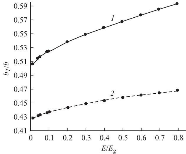
Рис. 1. Зависимость  $b_T/b$  от  $E/E_g$  для GaAs (1) и Ge (2).
