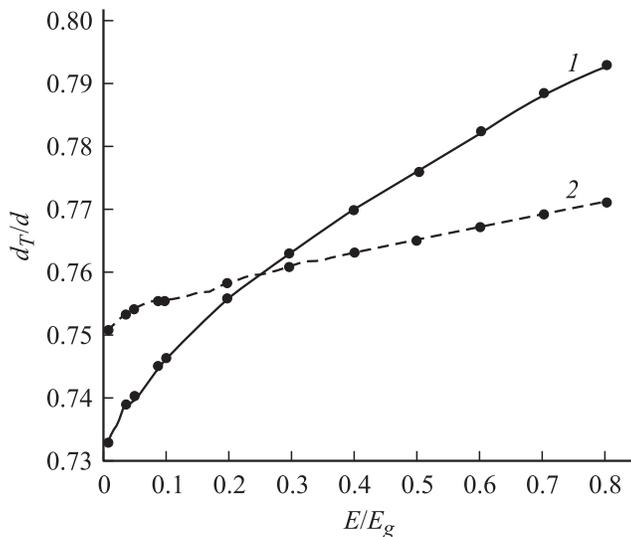
Рис. 2. Зависимость  $d_T/d$  от  $E/E_g$  для GaAs (1) и Ge (2).
