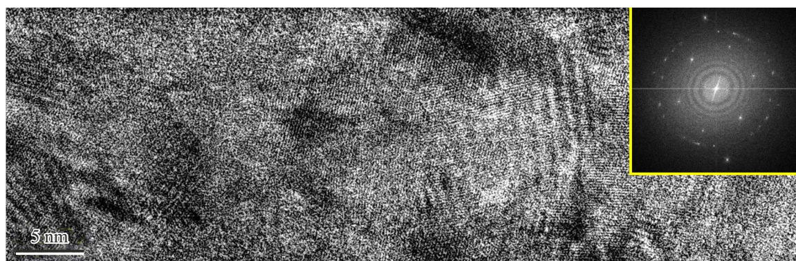
Рис. 10. ВРПЭМ-изображения перемешанной области образца NiFe|FeMn и соответствующее Фурье-преобразование от области снимка.
