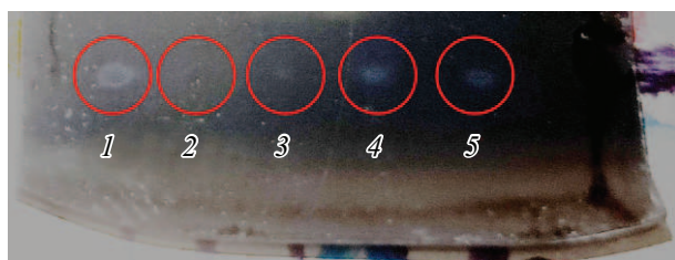
Рис. 3. Фотография образца TinS после проявления. Кругами обведены позиции пятен засветки.
