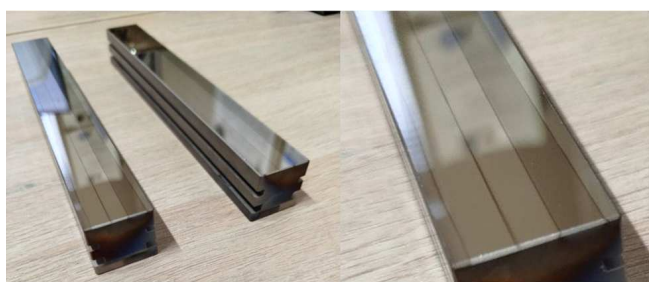
Рис. 7. Фотографии изготовленных подложек для монохроматора, с тремя отражающими МРЗ на поверхности. Слева — общая фотография двух подложек, справа — увеличенная.
