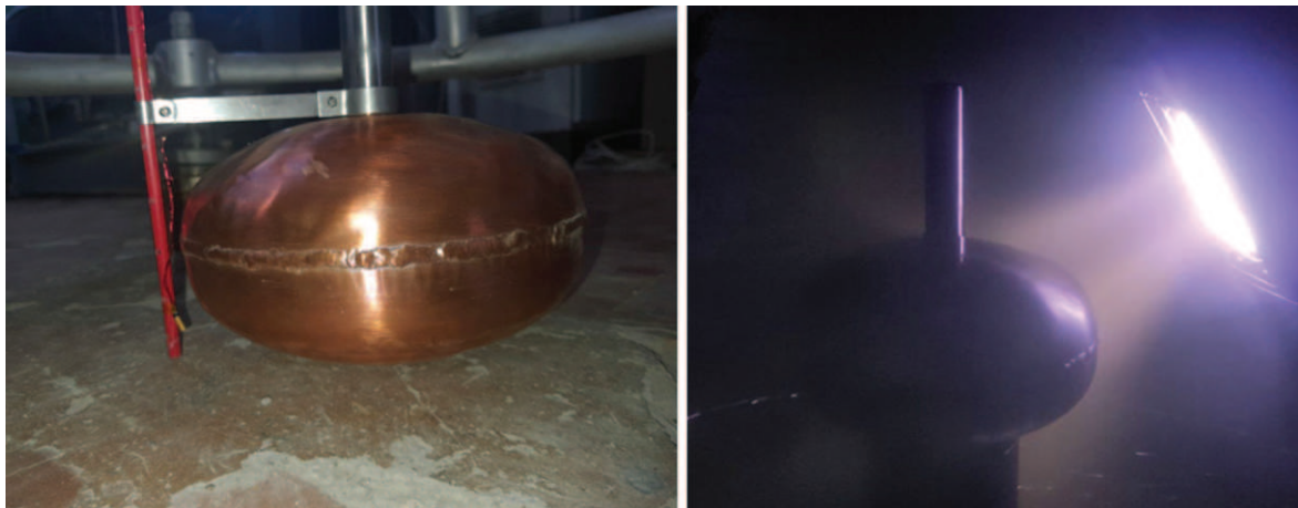
Рис. 3. Медная камера с уровнемером (слева) и напыление никеля на камеру (справа).
