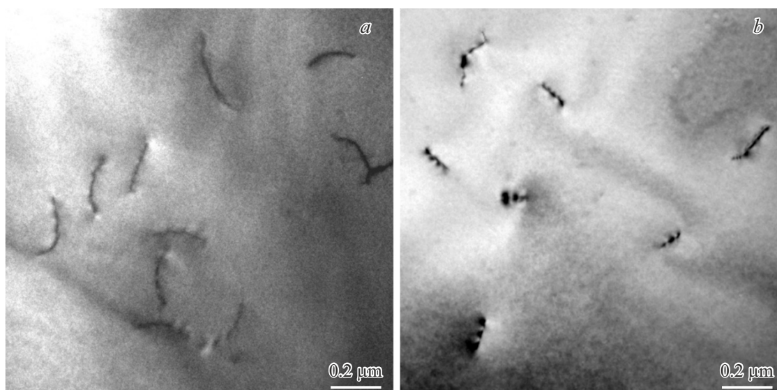
Рис. 5. Светлопольные ПЭМ-изображения сечения в планарной геометрии селективно выращенного слоя GaAs в центральной части окна, полученные вблизи оси зоны [001]: a — образец типа 1, b — образец типа 2.
