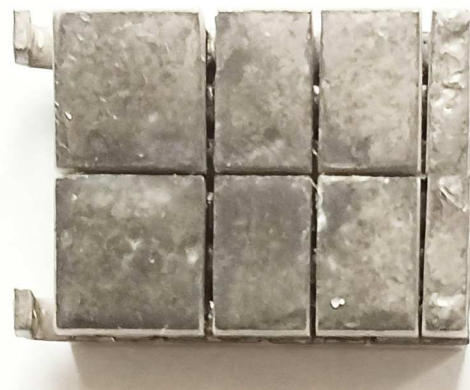
Рис. 3. Внешний вид охладителя с залуженной охлаждаемой поверхностью.
