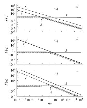
Зависимости формфактора F(q) от волнового вектора q для потенциальной ямы конечной высоты, полученные при следующих параметрах:  $U_0=0.5$  эВ,  $m=0.023m_0$  (символы 4). Ширина ямы, Å: a — 7, b — 70 и c — 700. Представлены расчеты по выражениям: I — (47), 2 — (49). Линия 3 соответствует значению F(q)=1.
