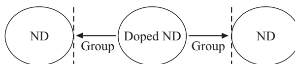
Рис. 10. Две нелегированные DND-частицы, соединенные с центральной, легированной DND-частицей.
