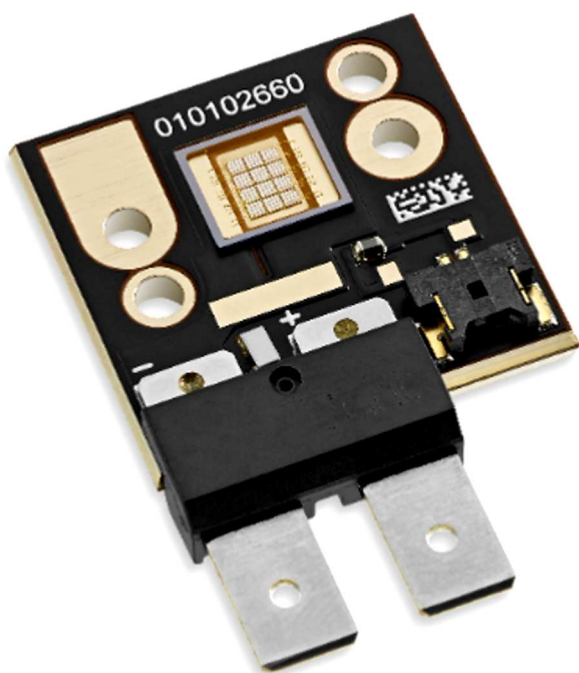
Рис. 1. Внешний вид матричного светодиодного излучателя CBM-120-UV. Заимствовано из [10].
