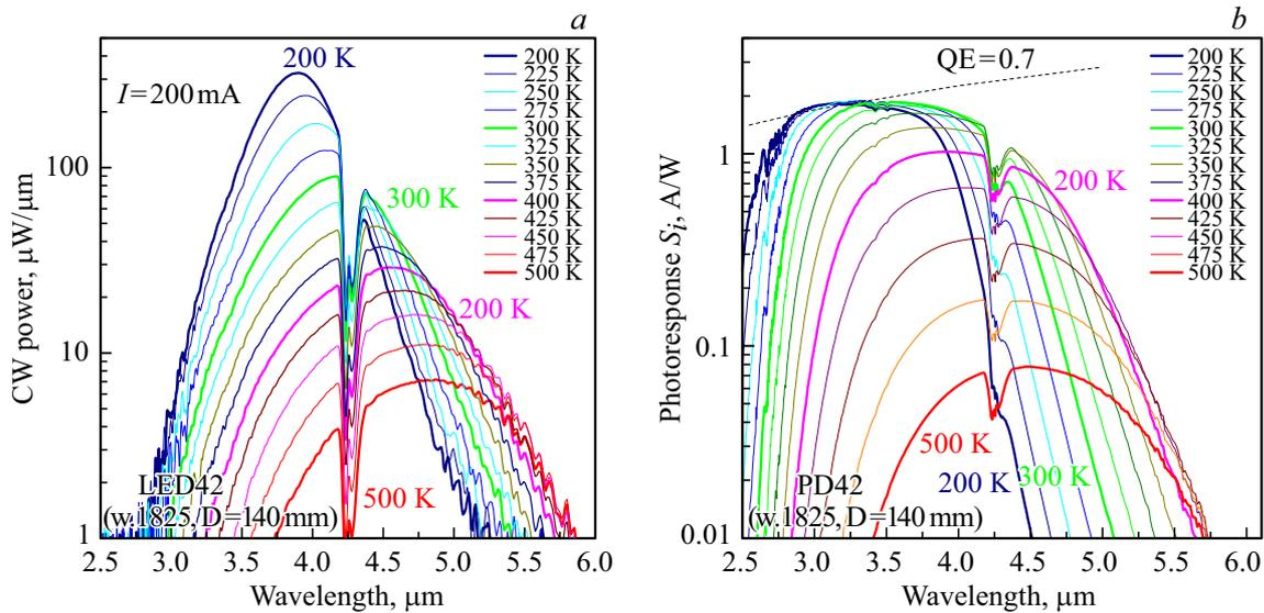
Рис. 1. Спектры электролюминесценции (а) и токовой чувствительности (b) в интервале температур 200–500 К.
