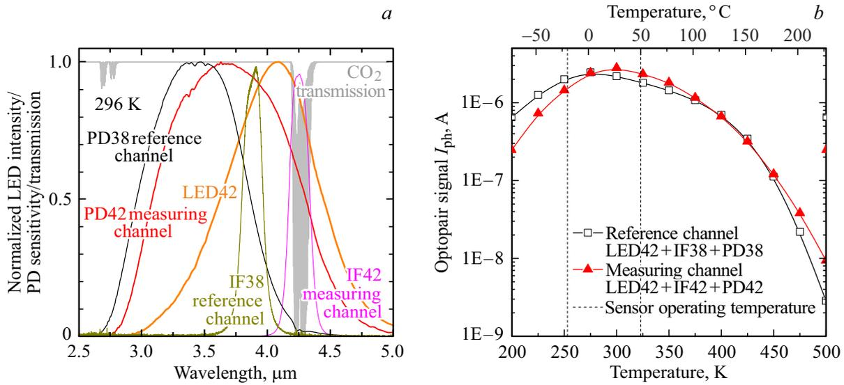
**Рис. 2.** Нормированные спектральные характеристики используемых оптоэлектронных компонентов и поглощение CO<sub>2</sub> (a); температурные зависимости сигналов оптопар измерительного и опорного каналов (b).
