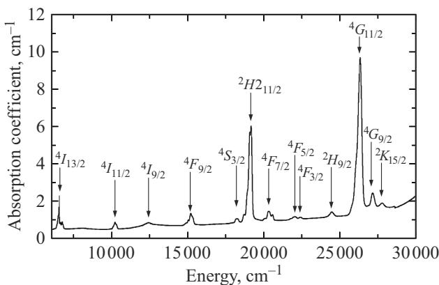
Спектр коэффициента поглощения для образца  $\text{LiNbO}_3$ , легированного  $\text{Er}^{3+}$ . Стрелками указаны линии поглощения, соответствующие переходам из основного состояния в возбужденные состояния в  $4f^{11}$ -оболочке. Конечные состояния обозначены над стрелками.
