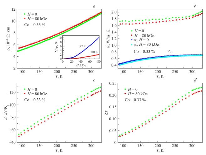
**Рис. 2.** График зависимости  $\rho(T)$ , k(T), S(T) и ZT(T) для композита  $\mathrm{Bi}_2\mathrm{Te}_{2.1}\mathrm{Se}_{0.9}+0.33$  wt.% Со в магнитном поле 80 kOe и без поля. На вставке рис. 2, a показаны зависимости магнитосопротивления  $\Delta\rho/\rho$  от магнитного поля, измеренные при T=77 и 300 K.
