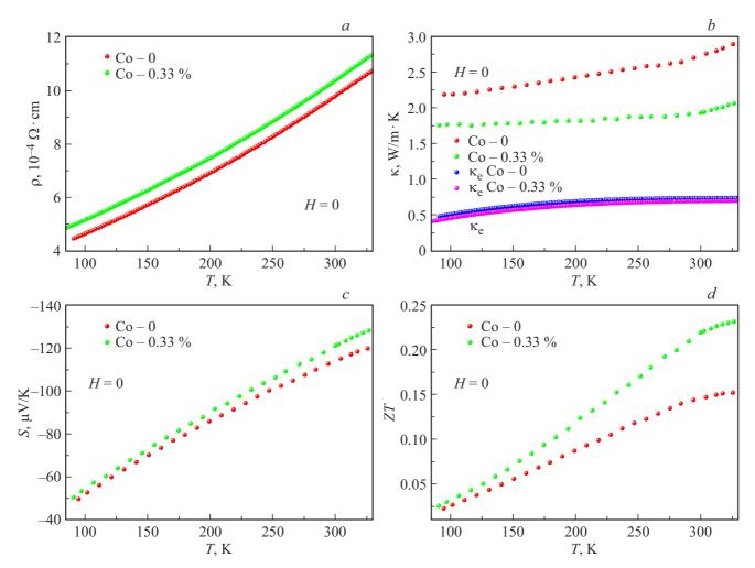
**Рис. 1.** Температурная зависимость электросопротивления (a), теплопроводности (b), термоэдс (c) и термоэлектрической добротности (d) для матрицы  $Bi_2Te_{2.1}Se_{0.9}$  (Co-0) и композита  $Bi_2Te_{2.1}Se_{0.9} + 0.33$  wt.% Co (Co-0.33%).
