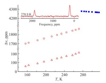
**Рис. 2.** Температурные зависимости сдвигов частоты линий ЯМР  $^{71}$ Gа для расплавленного галлия (синие квадраты) и ориентированного  $\alpha$ -Ga (красные кружки и треугольники). На вставке — спектр ЯМР  $^{71}$ Gа для ориентированного  $\alpha$ -Ga при температуре 270.9 К.
