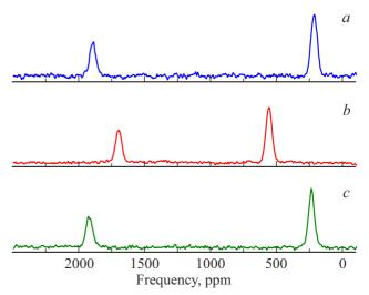
**Рис. 3.** Спектры ЯМР  $^{71}$ Gа при температуре 270.9 К для  $\alpha$ -Ga сразу после кристаллизации (a), после поворота образца на 25° (b), после нагрева образца до температуры 314 К и последующего охлаждения до 270.9 К (c).
