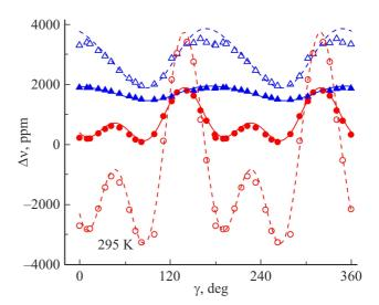
**Рис. 6.** Зависимости сдвигов линий ЯМР в ориентированном  $\alpha$ -Ga от угла поворота  $\gamma$  для <sup>69</sup>Ga и <sup>71</sup>Ga (пустые и заполненные символы соответственно) для двух магнитонеэквивалентных позиций. Сплошные и пунктирные линии — подгонка по формулам (2)-(4).
