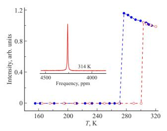
**Рис. 1.** Температурная зависимость интегральной интенсивности сигнала ЯМР  $^{71}$ Gа для расплавленного галлия при охлаждении (синие заполненные кружки) и нагреве (красные пустые кружки). Штриховые линии проведены для наглядности. На вставке: линия ЯМР изотопа  $^{71}$ Gа в расплавленном галлии при температуре  $314\,\mathrm{K}$ .
