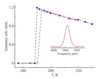
**Рис. 4.** Температурная зависимость интегральной интенсивности сигнала ЯМР  $^{71}$ Gа для расплавленного галлия при охлаждении образца от температуры 340 K до 233 K (синие заполненные кружки) и последующем нагреве (красные пустые кружки). Штриховые линии проведены для наглядности. На вставке — линия ЯМР  $^{71}$ Gа для ориентированного  $\beta$ -Gа при 257 K.
