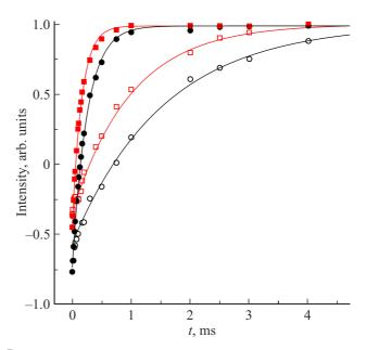
**Рис. 5.** Кривые восстановления линий ЯМР после инверсии при температуре 295 К для ориентированной  $\alpha$ -фазы и при температуре 260 К для ориентированной  $\beta$ -фазы. t — время между инвертирующим и 90-градусным импульсами. Квадраты —  $^{69}$ Ga, круги —  $^{71}$ Ga. Заполненные и пустые символы —  $\beta$ -Ga и  $\alpha$ -Ga соответственно. Сплошные линии — подгоночные кривые.
