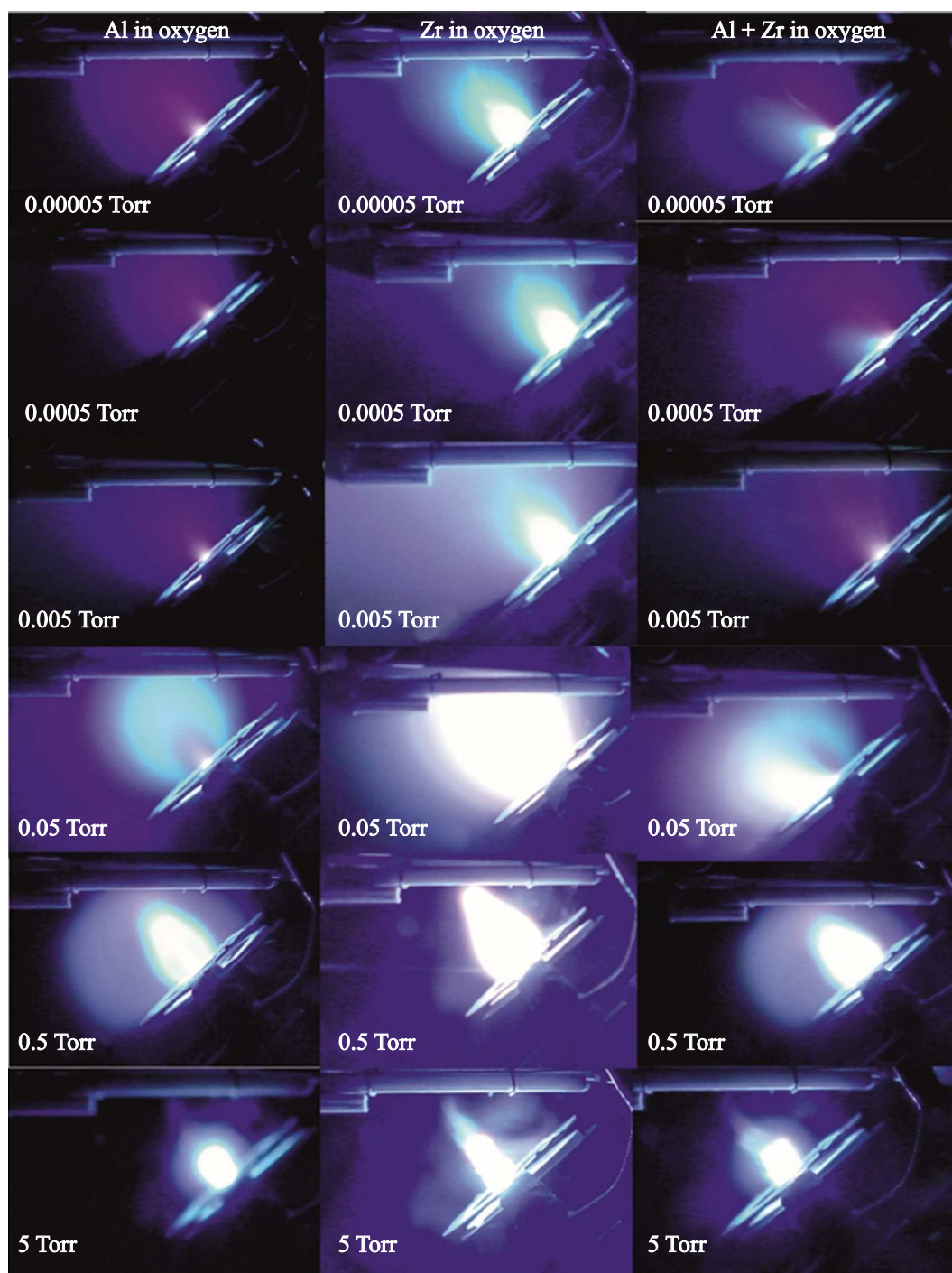
Рис. 7. Изображения плазменного факела при различном давлении кислорода: Al, Zr, смесь Al:Zr в соотношении 1 : 1.
