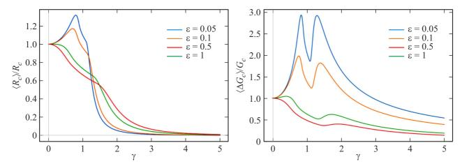
**Рис. 1.** Усредненные критический радиус и энергия образования зародыша как функции амплитуды модуляции давления при разных значениях параметра  $\varepsilon$  (относительная высота барьера нуклеации).
