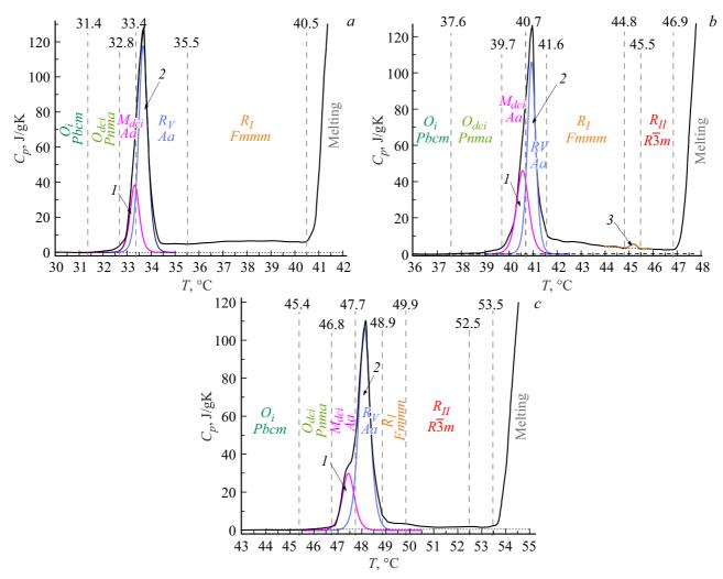
**Рис. 2.** Последовательность фаз при нагревании н-алканов C21 (a), C23 (b) и C25 (c), отмеченная на ДСК термограммах. Цифрами указаны РФП, которые были выделены среди всех твердофазных переходов.
