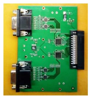
**Рис. 6.** Оцифровывающая плата первичного тригтера электромагнитного калориметра.
