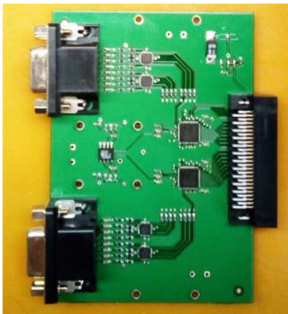
Рис. 6. Оцифровывающая плата первичного триггера электромагнитного калориметра.
