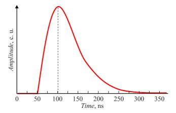
**Рис. 4.** Типичная форма суммарного сигнала на входе первичного тригтера.
