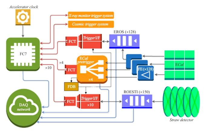
**Рис. 5.** Блок-схема триггерной системы эксперимента СОМЕТ с детектором на основе дрейфовых трубок и электромагнитного калориметра.
