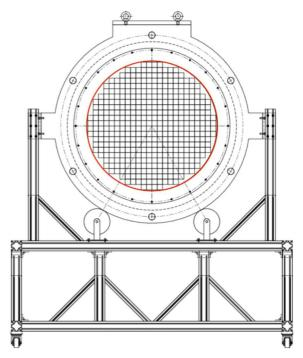
**Рис. 2.** Схематическое изображение электромагнитного калориметра.
