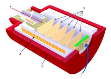
**Рис. 1.** Детекторная секция эксперимента СОМЕТ: 1 — пучок электронов, 2 — координатная система на основе дрейфовых трубок, 3 — электромагнитный калориметр, 4 — соленоид детектора, 5 — ярмо.
