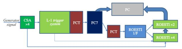
**Рис. 11.** Функциональная блок-схема аппаратуры для измерений времени принятия решения и задержки выработки триггерного сигнала.
