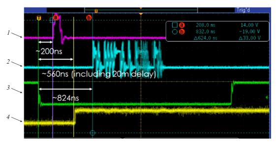
**Рис. 12.** Осциллограмма сигналов в ключевых точках электронного тракта электромагнитного калориметра: 1 — сигнал "быстрого" триггера, 2 — сигнал запуска чтения, выработанный FC7, на входе в плату EROS, 3 — сигнал на выходе генератора, 4 — сигнал центрального триггера на входе платы EROS.
