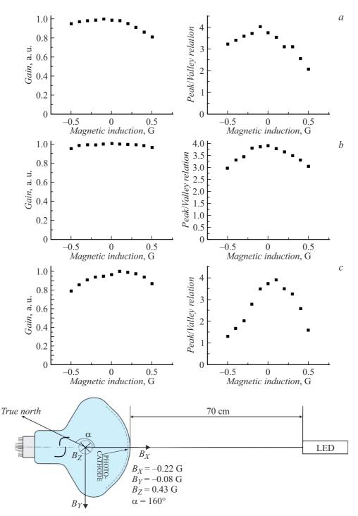
**Рис. 3.** Зависимость коэффициента усиления и отношения P/V при однофотоэлектронной засветке фотокатода от изменения индукции магнитного поля: a — вдоль компоненты X; b — вдоль компоненты Y; c — вдоль компоненты Z.
