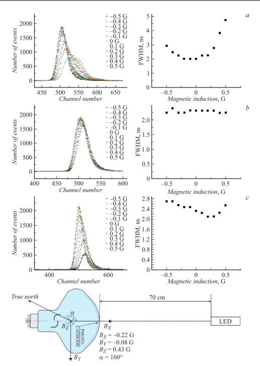
**Рис. 4.** Зависимость распределений времен пролета фотоэлектронов при однофотоэлектронной засветке фотокатода от изменения индукции магнитного поля: a — вдоль компоненты X; b — вдоль компоненты Y; c — вдоль компоненты Z.
