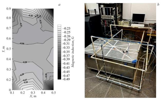
**Рис. 2.** Карта магнитной индукции, создаваемой катушками Гельмгольца (a); стенд для исследования влияния магнитного поля на параметры  $\Phi \ni \mathbf{y}$  (b).
