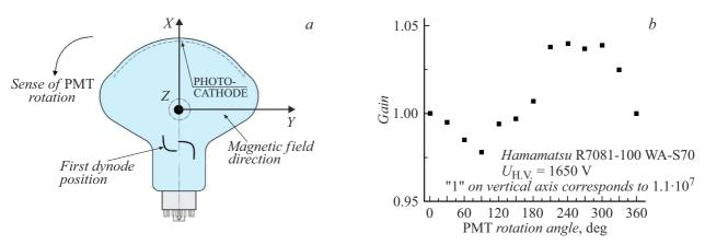
**Рис. 1.** Влияние магнитного поля Земли на коэффициент усиления  $\Phi$ ЭУ: a — положение  $\Phi$ ЭУ, вид сверху, b — зависимость усиления от угла поворота  $\Phi$ ЭУ в естественном магнитном поле Земли.
