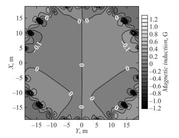
**Рис. 6.** Карта магнитной индукции, создаваемой катушками в направлении оси *Y*.
