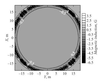
**Рис. 7.** Карта магнитной индукции, создаваемой катушками в направлении оси *Z*.
