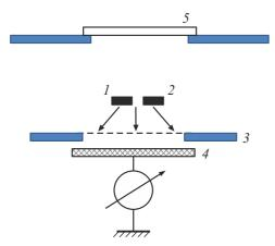
**Рис. 1.** Упрощенная схема экспериментальной установки: 1 — чистая рениевая лента; 2 — рениевая лента с покрытием из окиси иттрия; 3 — антидинатронная сетка; 4 — коллектор; 5 — окно для пирометрирования.
