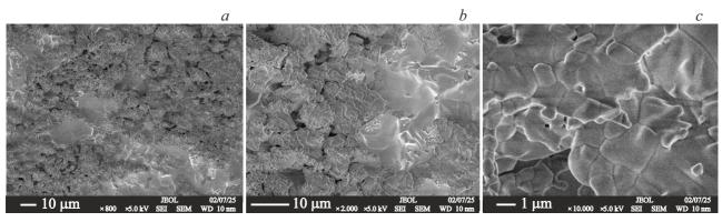
**Рис. 4.** Электронные микрофотографии поверхности рениевой ленты, активированной оксидом иттрия. Масштабы рисунков a и c различаются в 10 раз.
