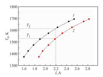
**Рис. 2.** Зависимость яркостной температуры чистого рения (I) и рениевого образца с покрытием из окиси иттрия (2) от тока накала ленты.
