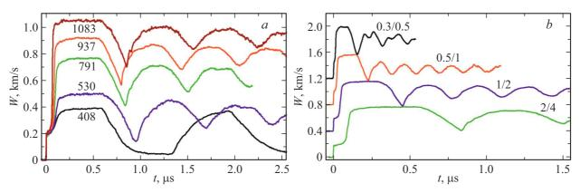
**Рис. 2.** . Профили скорости свободной поверхности образцов из сплава BT8 при нормальной начальной температуре: a — при вариации интенсивности ударной волны; b — при вариации длительности нагружающего импульса.
