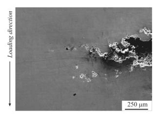
**Рис. 9.** Поры в образце из сплава BT8 после нагружения с  $V=(937\pm1.8)\,\mathrm{m/s}$  при комнатной температуре.
