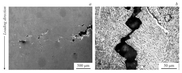
**Рис. 8.** Полосы локализации деформации и поры в конце магистральной трещины (a) и поры на сдвиговой трещине (b) в образце из сплава BT8 после нагружения с  $V=(532\pm1.1)\,\mathrm{m/s}$  при  $T=400\,^{\circ}\mathrm{C}$ : a — сканирующая электронная микроскопия; b — оптическая металлография.
