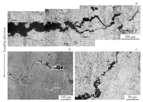
**Рис. 7.** Магистральная трещина (a) и мелкие трещины на ее концах (b, c) в образце из сплава BT8 после нагружения с  $V = (530 \pm 1.1) \, \text{m/s}$  при комнатной температуре: a, c — оптическая металлография; b — сканирующая электронная микроскопия.
