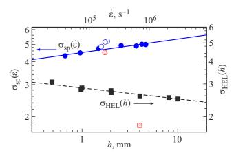
**Рис. 4.** Зависимость откольной прочности  $\sigma_{sp}(\varepsilon)$  титанового сплава BT8 от скорости деформации в волне разрежения (сверху) и зависимость динамического предела упругости  $\sigma_{\text{HEL}}(h)$  от расстояния пройденного волной в материале образца (снизу); красными символами отмечены данные при нагреве до 400 °C.
