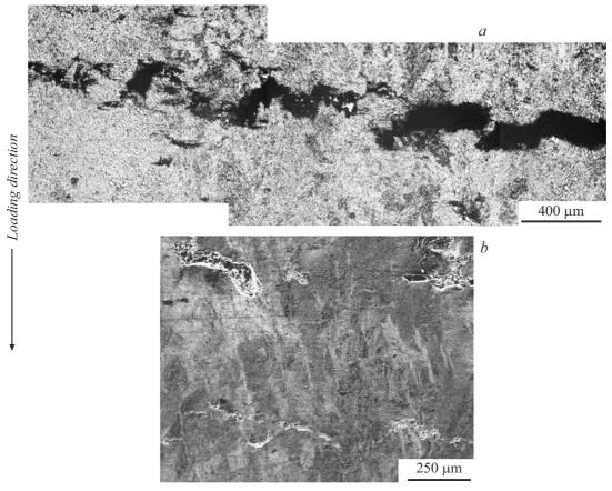
**Рис. 6.** Верхняя трещин (a) и фрагменты трещин (b) в поперечном сечении образца из сплава BT8 после нагружения с  $V=(537\pm1.1)\,\mathrm{m/s}$  при  $T=-80^{\circ}\mathrm{C}$ : a — оптическая металлография; b — сканирующая электронная микроскопия.
