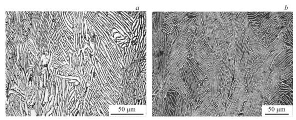
**Рис. 1.** Структура сплава BT8 в исходном состоянии: a — оптическая металлография; b — сканирующая электронная микроскопия.
