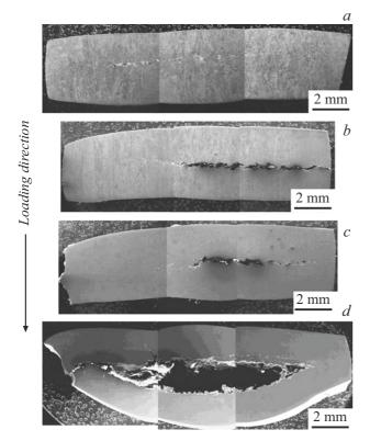
**Рис. 5.** Панорамные изображения поперечного сечения шлифов образцов из сплава BT8 после различных режимов нагружения, полученные в сканирующем электронном микроскопе:  $a-V=(537\pm1.1)\,\mathrm{m/s},\ T=-80\,^\circ\mathrm{C};$   $b-V=(539\pm1.1)\,\mathrm{m/s},\ Komhathas$  температура;  $c-V=(532\pm1.1)\,\mathrm{m/s},\ T=400\,^\circ\mathrm{C};\ d-V=(937\pm1.8)\,\mathrm{m/s},$  комнатная температура. Центр дисков находится с правой стороны.
