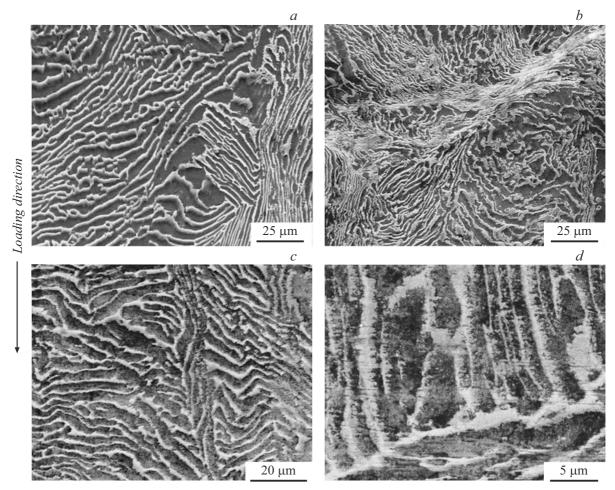
**Рис. 10.** Структура сплава BT8 после различных режимов нагружения:  $a-V=(530\pm1.1)\,\mathrm{m/s}$ , комнатная температура;  $b-V=(532\pm1.1)\,\mathrm{m/s}$ ,  $T=400\,^{\circ}\mathrm{C}$ ;  $c,d-V=(937\pm1.8)\,\mathrm{m/s}$ , комнатная температура.
