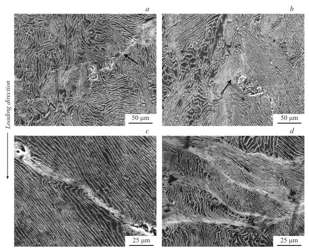
**Рис. 11.** Полосы локализации деформации в образце из сплава BT8 после различных режимов нагружения:  $a-V=(537\pm1.1)\,\mathrm{m/s},\ T=-80\,^{\circ}\mathrm{C};\ b-V=(530\pm1.1)\,\mathrm{m/s},\ \mathrm{komhathas}\ \mathrm{temnepatypa};\ c,\ d-V=(532\pm1.1)\,\mathrm{m/s},\ T=400\,^{\circ}\mathrm{C}.$
