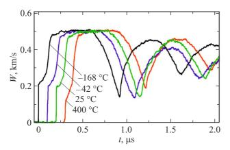
**Рис. 3.** Сравнение профилей скорости свободной поверхности образцов титанового сплава BT8 при различных начальных температурах.
