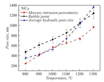
**Рис. 8.** Сравнение результатов определения размера пор в керамических материалах на основе SiC<sub>P</sub> различными методами.
