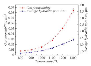
**Рис. 6.** Газопроницаемость и среднегидравлический размер пор в керамических материалах на основе  $SiC_P$ .
