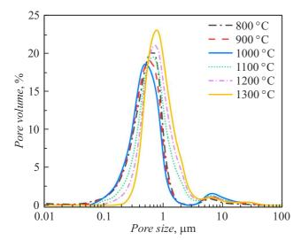
**Рис. 7.** Распределение пор по размерам в керамических материалах на основе SiC<sub>P</sub>.
