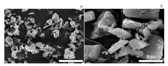
**Рис. 1.** Микроструктура порошка-заполнителя SiC<sub>P</sub>.
