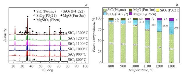
**Рис. 4.** Дифрактограмма (a) и гистограмма количественного анализа (b) пористых керамических SiC-материалов.
