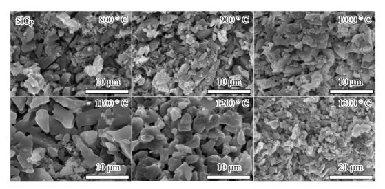
**Рис. 3.** Микроструктура пористых керамических SiC-материалов.
