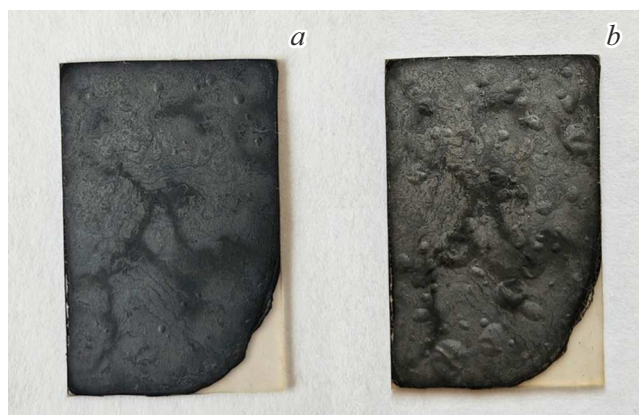
Рис. 8. Фотографии пленки композита Nafion-G-Pt/C исходного состава 14:56:30 до (a) и после (b) обработки реактивом Фентона.
