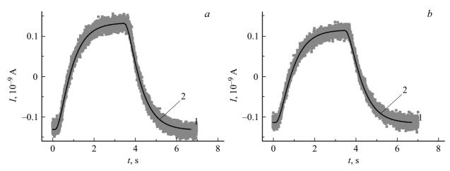
**Рис. 4.** Пироотклик TL, наблюдаемый в эксперименте (кривые I) и рассчитанный (кривые 2) при прохождении температурной волны через образцы ДГ (a) и БДГ (b) в кристаллографическом направлении  $\langle 111 \rangle$ .
