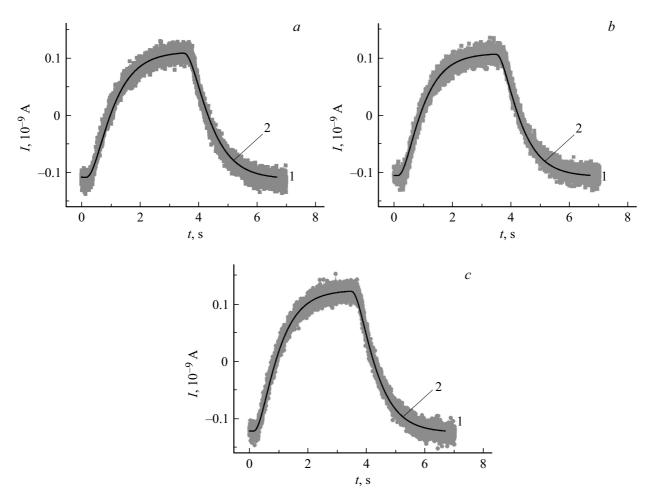
**Рис. 3.** Пироотклик TL, наблюдаемый в эксперименте (кривые I) и рассчитанный (кривые 2) при прохождении температурной волны через образцы ДГ (a) и БДГ (b) в кристаллографическом направлении  $\langle 100 \rangle$ , и образец ГП (c).
