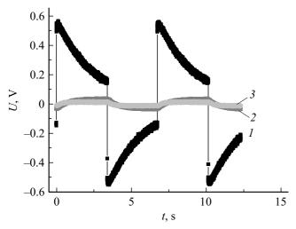
**Рис. 2.** Пироотклик кристалла TL, наблюдаемый при непосредственном воздействии модулированной тепловой волны на образец (кривая 1) и при прохождении температурной волны через образец кристалла Ge: с дислокациями (кривая 2) и бездислокацонного (кривая 3), помещенных на кристалл TL.
