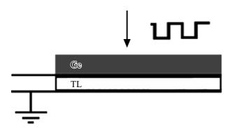
**Рис. 1.** Схема регистрации пироотклика при измерении коэффициентов теплопроводности и температуропроводности ТSМ-методом.
