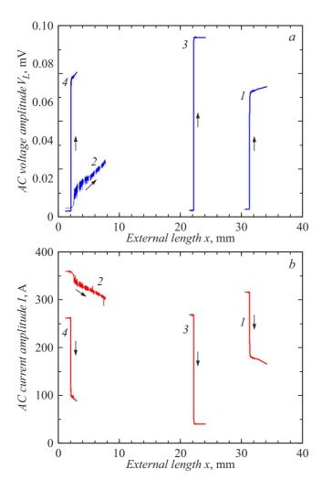
**Рис. 3.** Зависимости амплитуд напряжения и тока от длины наружного ("оголившегося") участка провода x при понижении уровня жидкого азота; a — напряжение с полной длины провода  $V_L$ , b — ток I. I-4 — варианты проведения измерений.
