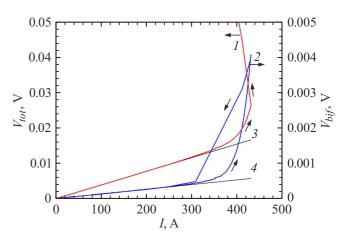
**Рис. 6.** Амплитудная ВАХ образца с бифилярным участком в жидком азоте: I — суммарный сигнал, 2 — сигнал с бифилярного участка, 3 —  $V_{tot} = 38.7 \cdot 10^{-6}I$ , 4 —  $V_{bif} = 1.33 \cdot 10^{-6}I$ .
