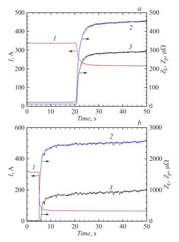
**Рис. 4.** Зависимости от времени тока и сопротивлений разных участков образца ВТСП провода при S-N-переходе, вызванном снижением уровня жидкого азота: I — амплитуда тока, 2 — сопротивление всего образца  $Z_L$ , 3 — сопротивление внутренней части образца  $Z_p$ ; a — образец с Си-стабилизатором, b — образец без стабилизатора.
