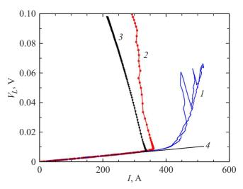
**Рис. 2.** Амплитудная ВАХ образца стабилизированного ВТСП провода: I — образец полностью в жидком азоте, 2 — оголенная длина  $x=33\,\mathrm{mm}$ , режим управляемого повышения питающего напряжения, 3 — оголенная длина  $x=22.5\,\mathrm{mm}$ , режим фиксированного питающего напряжения, 4 — линейная экстраполяция сверхпроводящего участка ВАХ.
