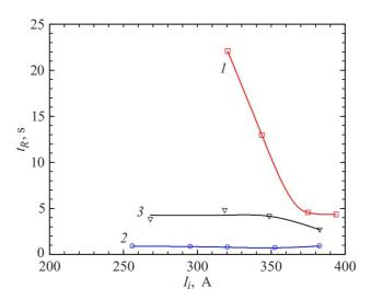
**Рис. 8.** Зависимости времени прохождения нормальной зоны между лентами в бифиляре от амплитуды начального тока  $I_i$ : I — вариант 5; 2 — вариант 6; 3 — вариант 7 (варианты измерений пронумерованы согласно табл. 2).
