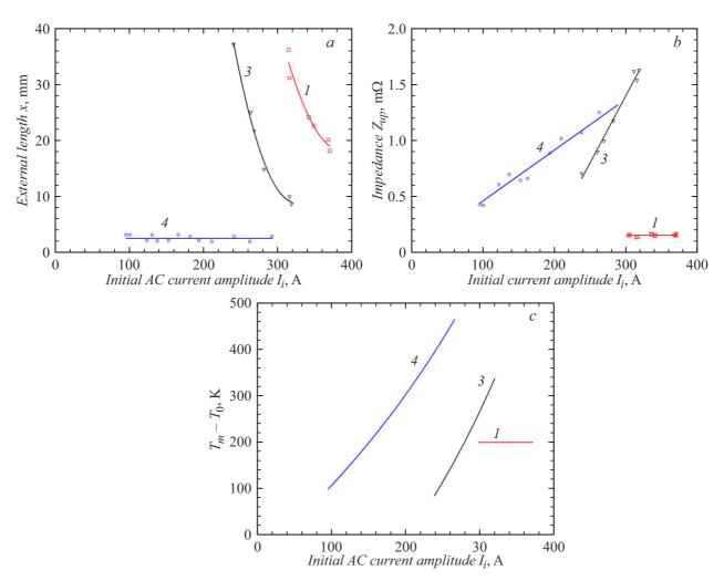
**Рис. 5.** Зависимость параметров при срабатывании от амплитуды начального тока  $I_i$ ; a — длина наружного участка x; b — сопротивление участка провода  $Z_{up}$ ; c — перегрев образца после срабатывания. 1, 3, 4 — варианты проведения измерений.
