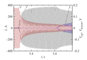
**Рис. 7.** Осциллограммы тока и сигналов напряжений с различных участков бифиляра: I — ток I(t), 2 — сигнал  $V_{top}(t)$  с верхней ленты бифиляра, 3 — сигнал  $V_{bottom}(t)$  с нижней ленты бифиляра.
