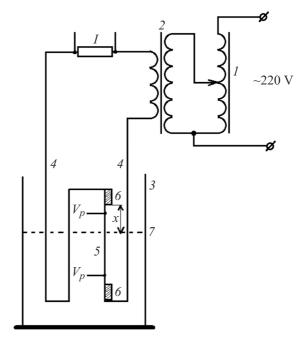
**Рис. 1.** Схема измерений: I — автотрансформатор, 2 — понижающий трансформатор, 3 — азотный криостат, 4 — токовводы (показан вариант охлаждения верхнего токоввода жидким азотом), 5 — образец ВТСП провода, 6 — токовые прижимные контакты, 7 — уровень жидкого азота. I — ток в цепи,  $V_p$  — потенциальные контакты.
