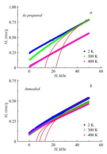
**Рис. 4.** Зависимости намагниченности от напряженности магнитного поля M(H) при различных температурах поликристаллических образцов замещенного феррита лантана-стронция  ${\rm La_{0.67}Sr_{0.33}FeO_{3-\delta}}$  до (a) и после (b) вакуумной термообработки. Сплошными красными линиями показаны аппроксимации (пояснения в тексте).
