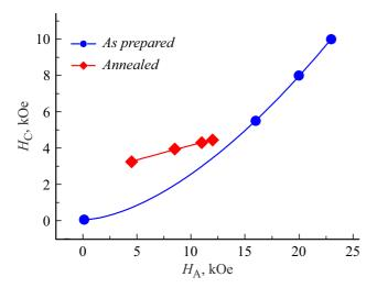
**Рис. 7.** Зависимости коэрцитивной силы от поля магнитной анизотропии  $H_{\rm C}(H_{\rm A})$  поликристаллических образцов замещенного феррита лантана-стронция  ${\rm La_{0.67}Sr_{0.33}FeO_{3-\delta}}$  до (синие символы) и после (красные символы) вакуумной термообработки. Сплошными линиями показаны аппроксимации (пояснения в тексте).
