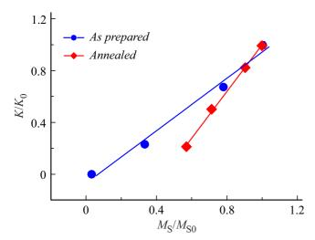
**Рис. 6.** Зависимости нормированной константы магнитной анизотропии  $K/K_0$  от нормированной намагниченности насыщения  $M_{\rm S}/M_{\rm S0}$  в поликристаллических образцах замещенного феррита лантана-стронция  ${\rm La_{0.67}Sr_{0.33}FeO_{3-\delta}}$  до (синие символы) и после (красные символы) вакуумной термообработки. Сплошными линиями показаны аппроксимации (пояснения в тексте).
