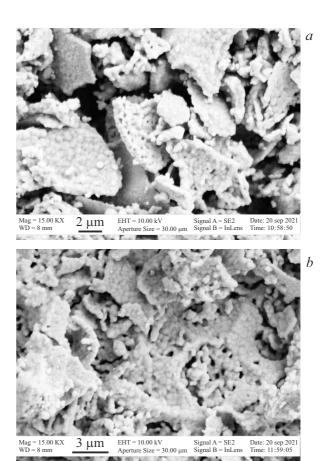
**Рис. 1.** Изображения, полученные с помощью сканирующей электронной микроскопии, образцов замещенного феррита лантана-стронция  $\text{La}_{0.67}\text{Sr}_{0.33}\text{FeO}_{3-\delta}$  до (a) и после (b) вакуумной термообработки.
