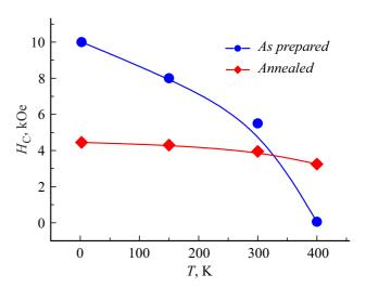
**Рис. 3.** Температурные зависимости коэрцитивной силы  $H_{\rm C}(T)$  поликристаллических образцов замещенного феррита лантана-стронция  ${\rm La_{0.67}Sr_{0.33}FeO_{3-\delta}}$  до (синие символы) и после (красные символы) вакуумной термообработки. Сплошными линиями показан сплайн.
