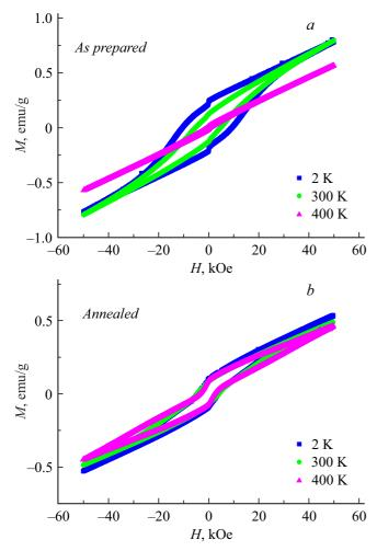
**Рис. 2.** Зависимости намагниченности от напряженности магнитного поля M(H) в виде петель гистерезиса при различных температурах поликристаллических образцов замещенного феррита лантана-стронция  $\text{La}_{0.67}\text{Sr}_{0.33}\text{FeO}_{3-\delta}$  до (a) и после (b) вакуумной термообработки.
