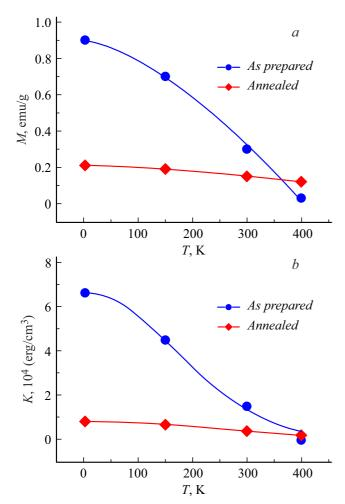
**Рис. 5.** Температурные зависимости намагниченности насыщения  $M_{\rm S}(T)$  (a) и константы магнитной анизотропии K(T) (b) поликристаллических образцов замещенного феррита лантанастронция  ${\rm La_{0.67}Sr_{0.33}FeO_{3-\delta}}$  до (синие символы) и после (красные символы) вакуумной термообработки. Сплошными линиями показаны аппроксимации (пояснения в тексте).
