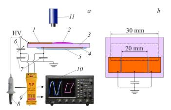
**Рис. 1.** a — изображение разрядной ячейки со схемой подключения: I — открытый (коронирующий) электрод, 2 — поверхностный барьерный разряд, 3 — керамический барьер, 4 — ответный электрод, 5 — компаунд, 6 — подстроечная емкость  $C_{comp}$ , 7 — измерительные емкости  $C_m$ , 8 — высоковольтный щуп, 9 — дифференциальный щуп, 10 — осциллограф, 11 — ПЗС-камера; b — изображение ответного электрода со схемой полключения.
