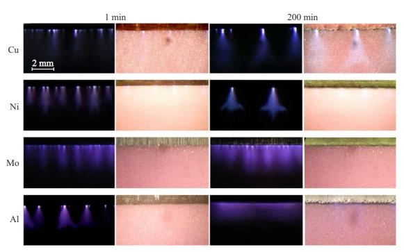
**Рис. 3.** Изображения разряда и электродов из различных материалов в первую минуту работы разряда и после непрерывной работы в течение 200 min. Экспозиция кадров 30 ms.
