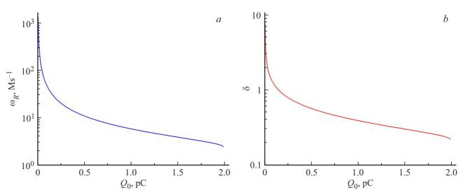
**Рис. 4.** Зависимости собственной частоты колебаний (a) и декремента затухания (b) для устойчивых радиусов от заряда на пузырьках. Параметры расчета такие же, как на рис. 3.
