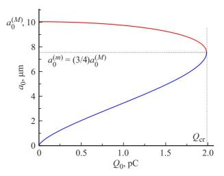
**Рис. 2.** Зависимость равновесного радиуса от заряда пузырька при  $p_0 = 0.1$  MPa,  $T_0 = 273$  K, Os = 1.7.
